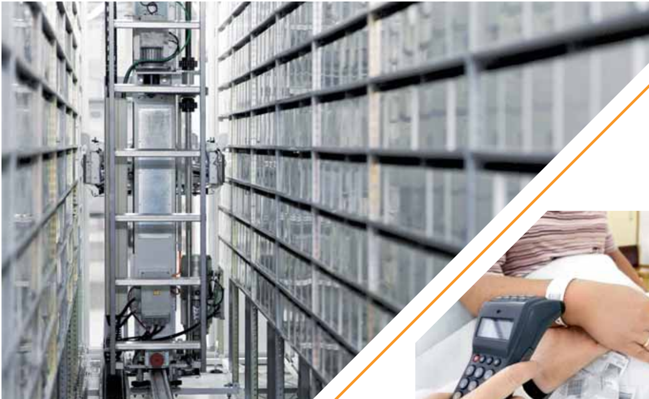
LINKS: INNENSICHT DES LAGERSYSTEMS BOXPICKER FÜR KRANKEN- HAUSAPOTHEKEN
